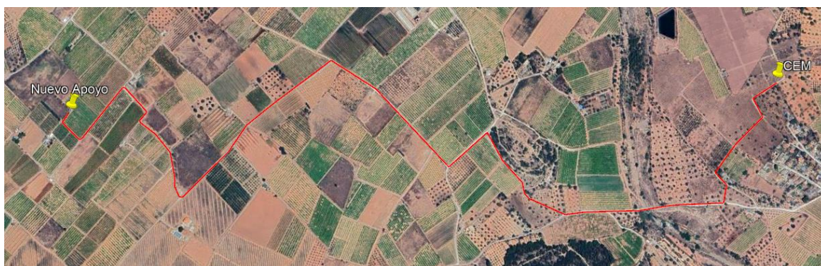
Ilustración 7: Representación sobre ortofotografía de la localización del CEM de Olocau y de la línea de Media Tensión hasta el Punto de Entronque.
